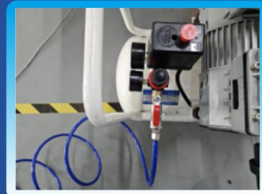
第五步：打开空压机阀门接通风冷， 探头前端有冷却压缩空气吹出
