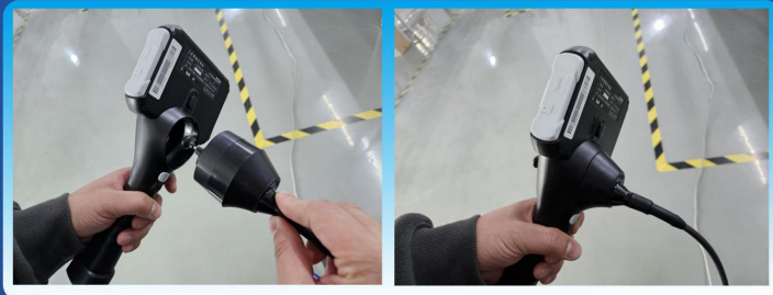
第一步 高温内窥镜管线和主机安装
