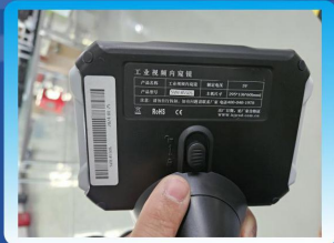
第二步 推动主机背板后按键，锁定管线
